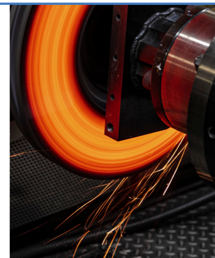
200km/hを超える高速走行から急ブレーキをかけ、ブレーキの性能を評価・検証
