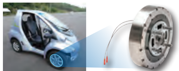
MR流体ブレーキ（試作品）とそれを搭載した超小型モビリティ
