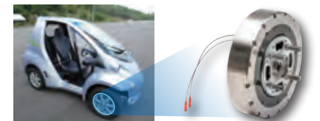
MR流体ブレーキ（試作品）とそれを搭載した超小型モビリティ
